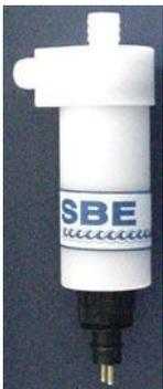
SBE 5M ポンプ・モジュールは遠心ポンプ・ヘッドから成り、耐深度 600m のプラスチック・ハウジングの中に DC ブラシモーターをコンパクトに格納した長寿命ポンプです。ポンプ・インペラーと電気駆動モーターはハウジングを通して磁氣的に結合しているため、筐体は完全密封されています。モーター・スピードとポンピング・レートは、入力電圧の全範囲(DC9~18V)において一定であり、モーター駆動のエレクトロニクスは、誤った逆極性に対して本質的に保護されています。
