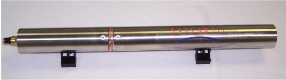
**SUNA V2**はMBARI(モントレー湾水族館研究所)で開発されたISUS(現場用硝酸塩計)の技術に基づいた薬品を使わない紫外線硝酸塩センサーの最新機器です。Satlantic社は、非常に濁った高いCDOM条件を含めた厳しい環境で硝酸塩を測定するために、SUNAを改良しました。改良されたオプティクスと搭載された論理的知能で、**SUNA V2**は海洋の硝酸塩躍層から河川に流入する雨水まで広範囲に渡る環境条件で、正確さと安定した硝酸塩を測定します。
