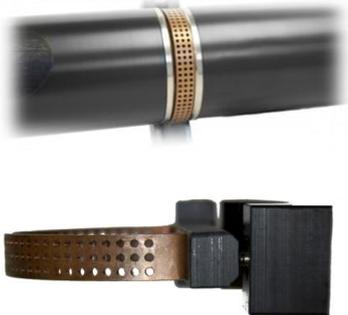
SUNA の防汚ガードは、サンプリング・チャンバーの中へ嵌めこむプラスチック製のアーマチャに取り付けられた穴のあいた銅製の半円形の部品です。防汚ガードは、銅イオンの放出を介してエリア内の生物の増殖を防ぐ受動的な汚れ防止です。防汚ガードは、係留用途のために観測時間を増やし、運用コストを削減して高品質なデータを集めるための信頼できる手頃なアプローチを提供します。
